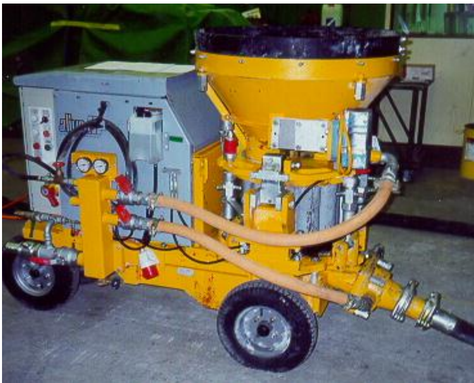
Figura 2.5. Equipo Shotcrete vía seca
