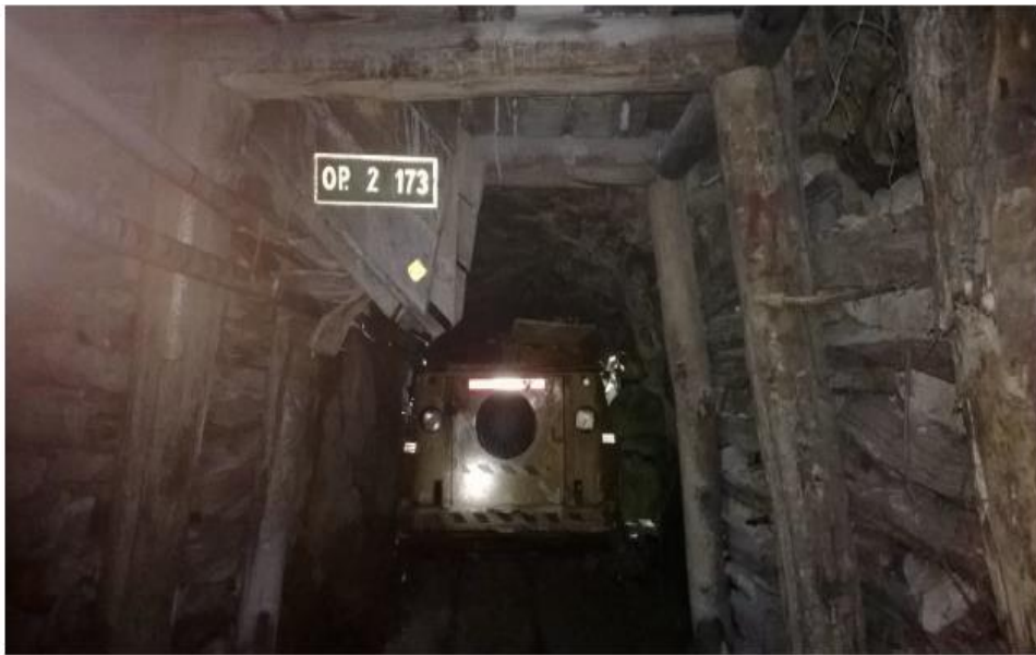
Figura 9: Equipo Scoop de 2.5 yardas relleno de área disparada
