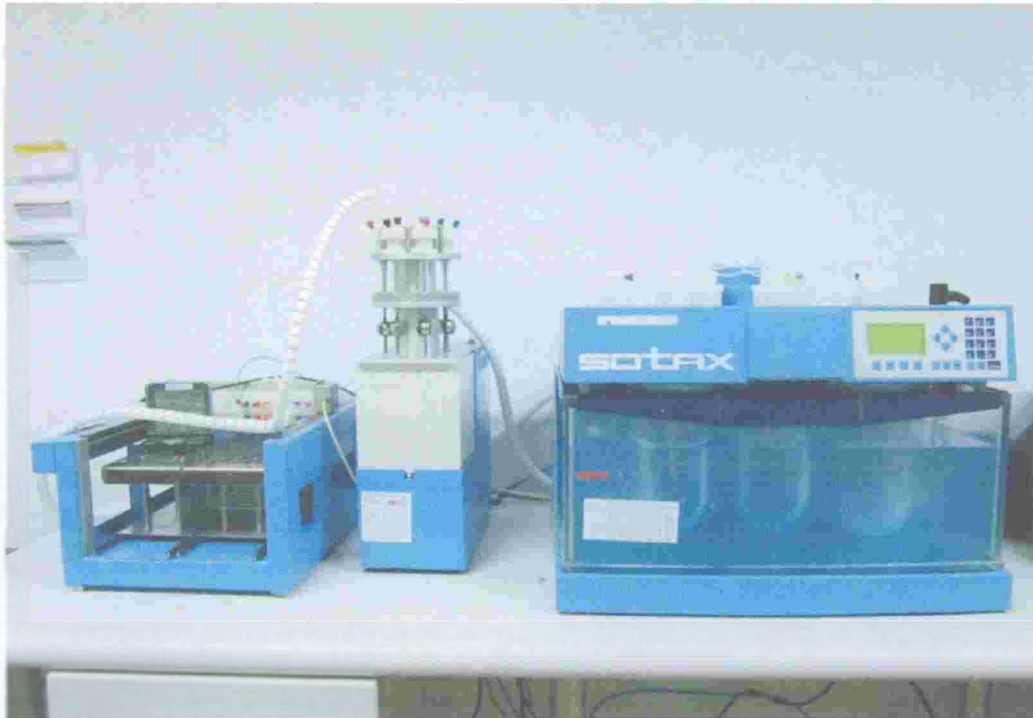
ANEXO N° 17: Equipo disolutor marca: Sotax modelo: SR7 Plus.
