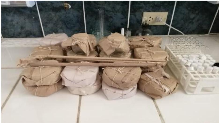
**Figura 2.4.** Esterilización de materiales
