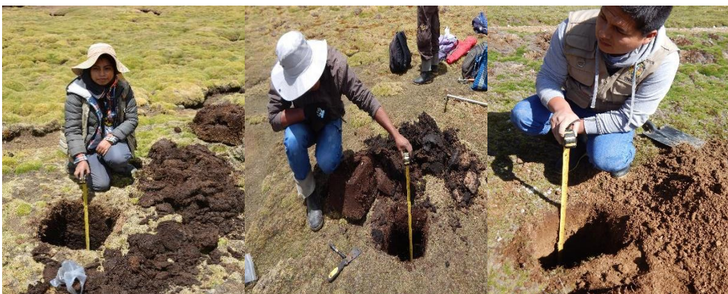
Tesista y ayudantes realizando la medición de la profundidad de la calicata con la ayuda de un flexómetro.
