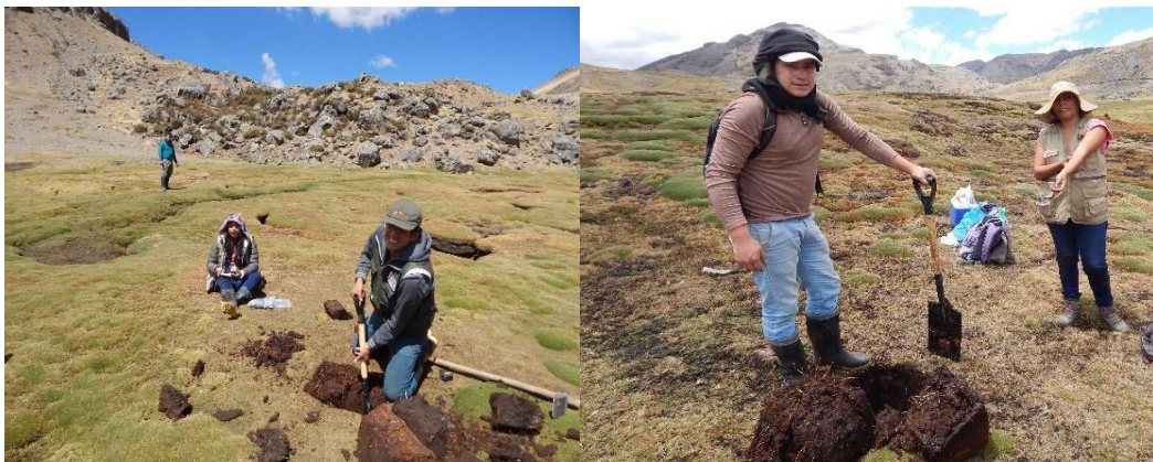
Ayudantes realizando las calicatas
