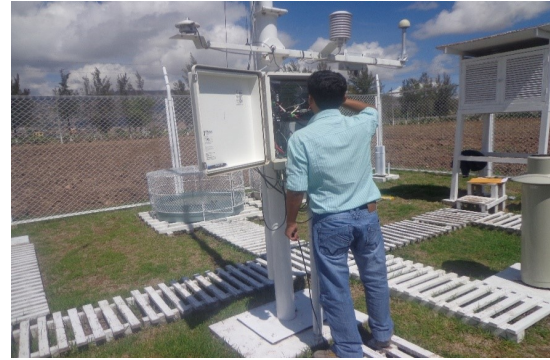
(b) Verificación y mantenimiento de las Estaciones meteorológicas automáticas
