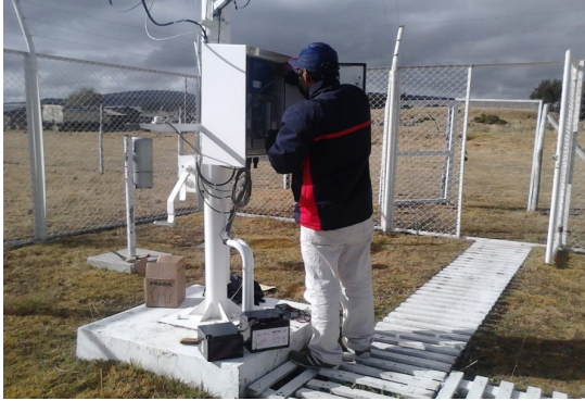
(a) Cambio de batería de 12 Voltios de la Estación Meteorológica Automática
