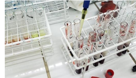
Agregar el reactivo Drabkin para la determinación de los valores de la hemoglobina a la muestra.
