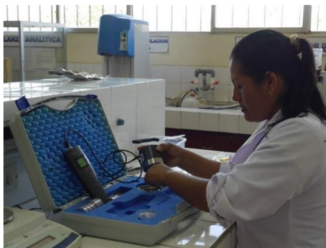
Figura 10. Medición directa de actividad de agua en filete de pescado.
