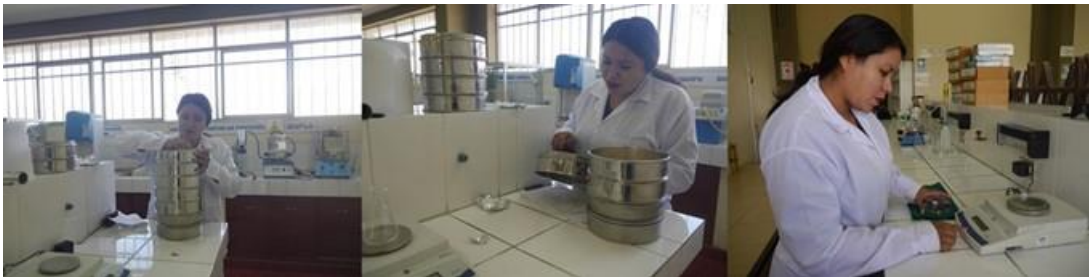
Figura 8. Proceso de tamizado de la muestra en el análisis granulométrico
