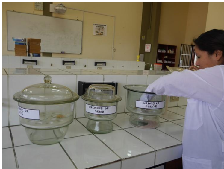
Figura 10. Desecadores con muestras para determinar humedad de equilibrio.
