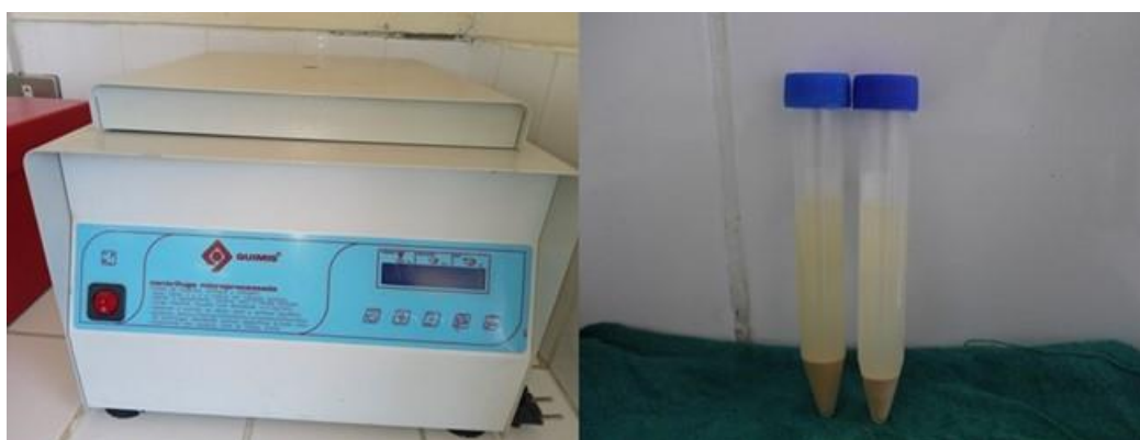
Figura 9. Muestras de tubos después de la sedimentación en la determinación de WSA y WAI
