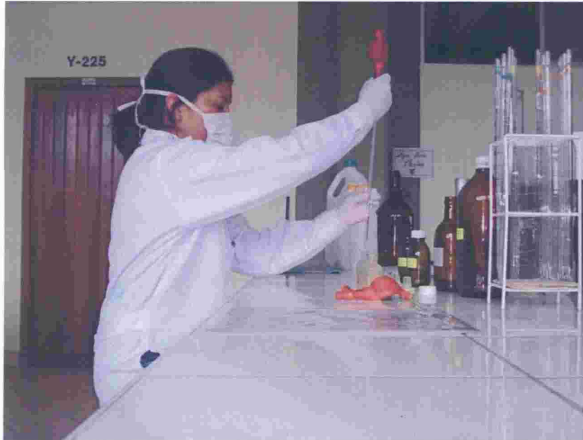
Fotografía N° 15: Medición de oxígeno disuelto, en aguas residuales por el método Winkler.
