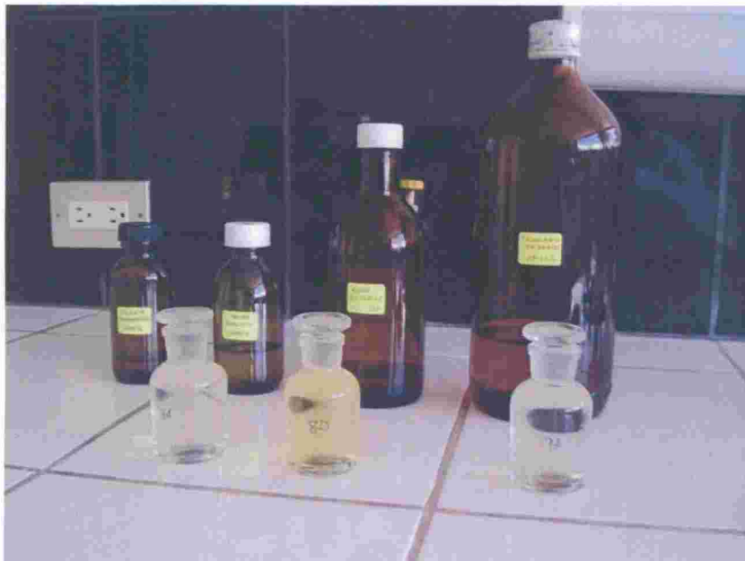
Fotografía N° 16: Frascos Winkler con muestras de agua residual después de la incubación de 5 días a 20 °C, en baño maría.
