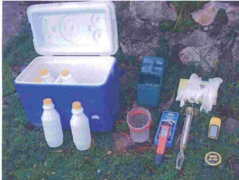
Fotografía N° 11: Materiales y equipos usados para la toma de muestra de aguas residuales.
