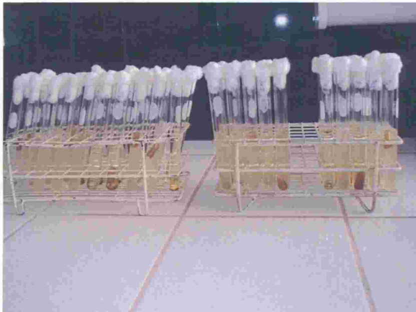
Fotografía N° 14: Tubos de prueba con muestras de agua residual para la numeración de coliformes fecales por la técnica de Numero Más Probable.
