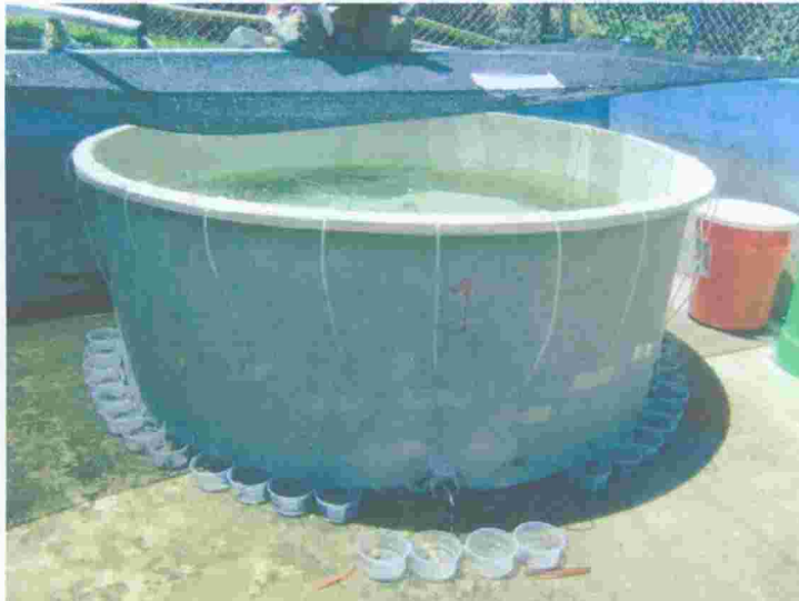
Fotografía N° 07: Instalación del sistema hídrico para el bioensayo (agua de manante, con ingreso constante y adicionado un aireador).
