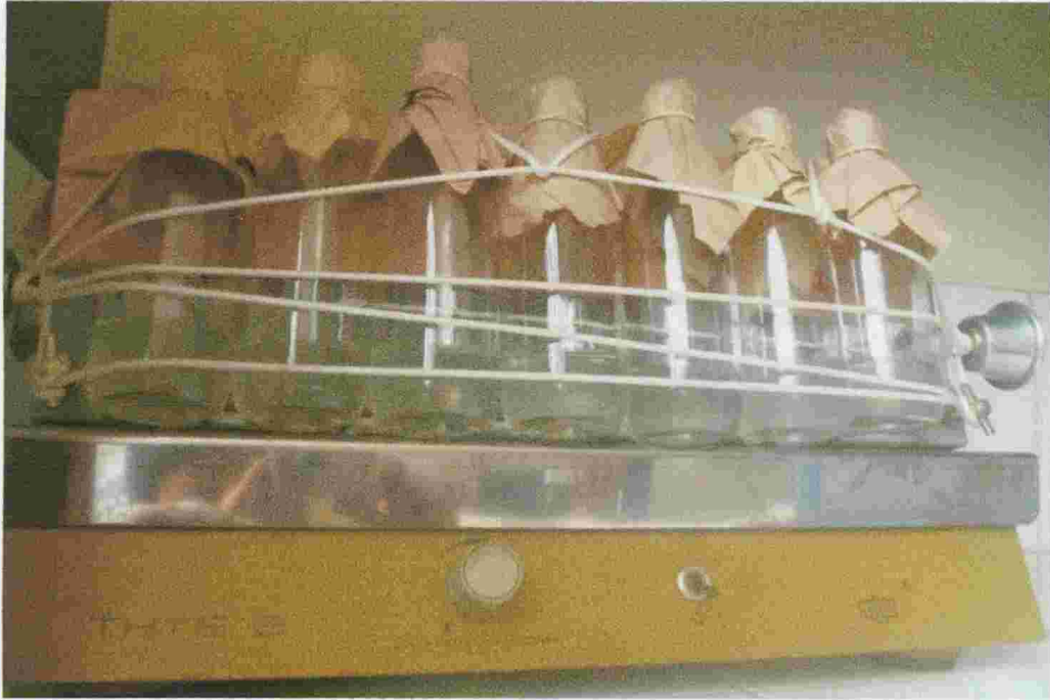
Figura 19. Agitador horizontal de frascos de vidrio.
