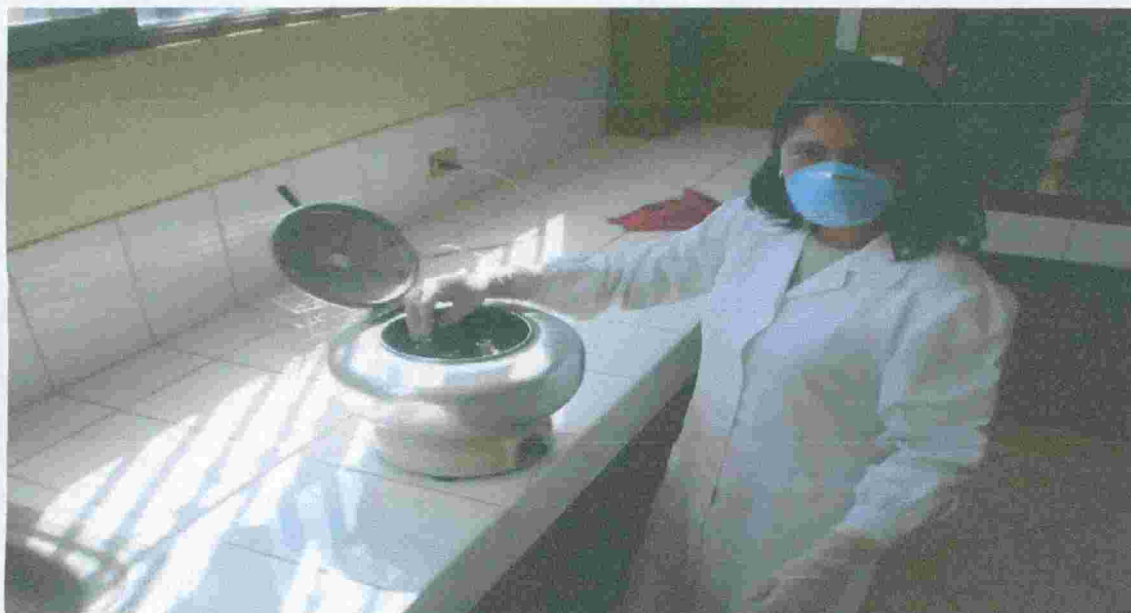
Fotografía 01: Procesamiento de la muestra en centrifuga para el análisis de identificación y cuantificación de enteroparásitos. UNSCH-Laboratorio de Microbiología.
