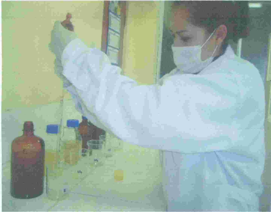
Fotografía N° 17: Toma de muestra de agua residual para determinar Nitratos.
