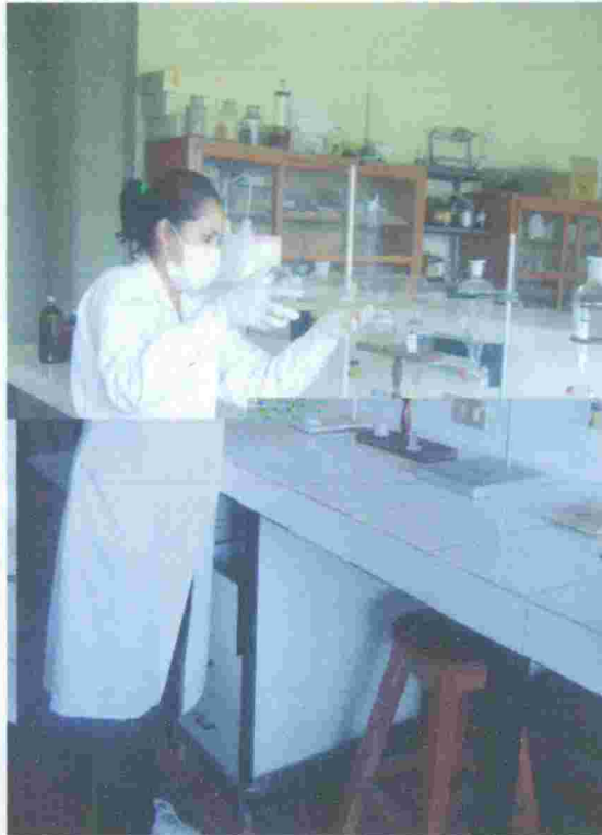
Fotografía N° 03: Disposición de la muestra de agua residual en las peras para determinar detergentes.
