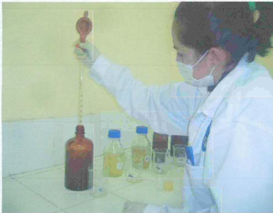
Fotografía N° 11: Toma de muestra para el análisis de Fosfatos
