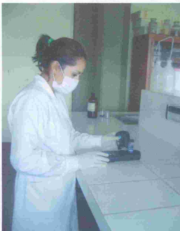
Fotografía N° 10: Realizando la lectura de la concentración de detergentes aniónicos en la muestra analizada.
