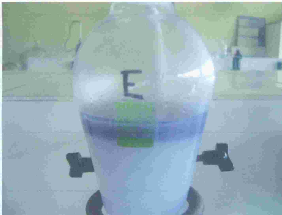
Fotografía N° 07: Se evidencia emulsión en la muestra del afluente de la Planta de Tratamiento de Aguas Residuales “La Tatora”.
