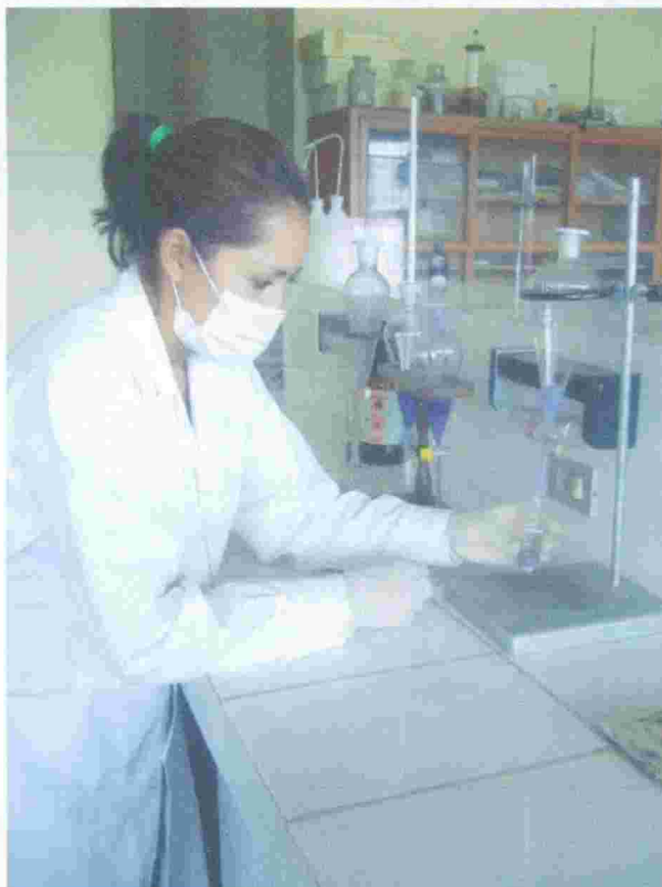
Fotografía N° 09: Derrame de la capa superior de la pera (Detergentes Aniónicos).
