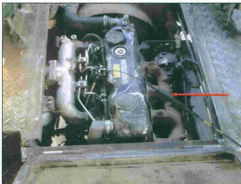
Fotografía N° 04: Medición de la temperatura del aceite por el sensor de aceite de motor en los vehículos a diesel
