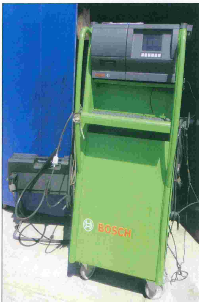
Fotografía Nº 01: Equipo integrado Gasómetro – Opacímetro para la medición de emisiones gaseosas de las unidades vehiculares motorizadas.
