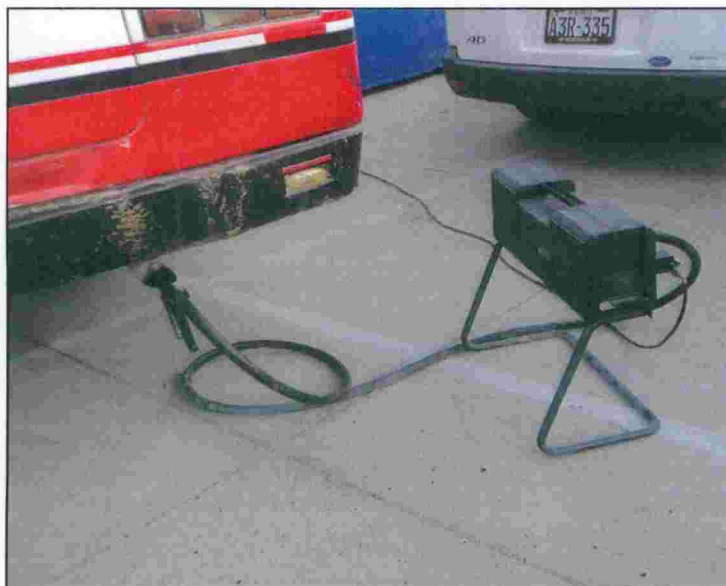
Fotografía N° 07: Medición del sensor de emisiones gaseosas en el tubo de escape de la unidad vehicular a diesel.
