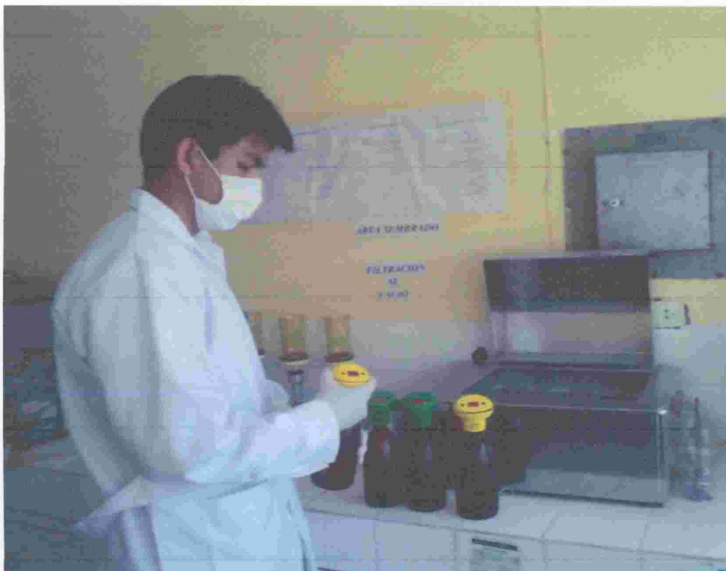
Fotografía N° 09: Asegurando y calibrando el equipo oxitop con muestras de agua residual de camal Quicapata para su posterior incubación por 5 días a 20 °C. Laboratorio de control de calidad de la Planta de Tratamiento de Agua Potable de Quicapata. Ayacucho 2011 – 2012.
