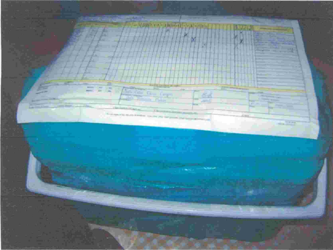
Fotografía N° 07: Cooler debidamente sellado y con la cadena de custodia, conteniendo las botellas con muestras de agua residual del camal Quicapata para el análisis respectivo en el laboratorio acreditado Certi Min. Laboratorio de control de calidad de la Planta de Tratamiento de Agua Potable de Quicapata. Ayacucho 2011 - 2012.
