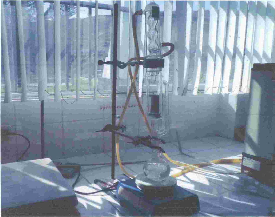
Fotografía N° 11: Proceso de extracción de aceites y grasas con el equipo de extracción Soxhlet. Laboratorio de control de calidad de la Planta de Tratamiento de Aguas Residuales Totorá. Ayacucho 2011 - 2012
