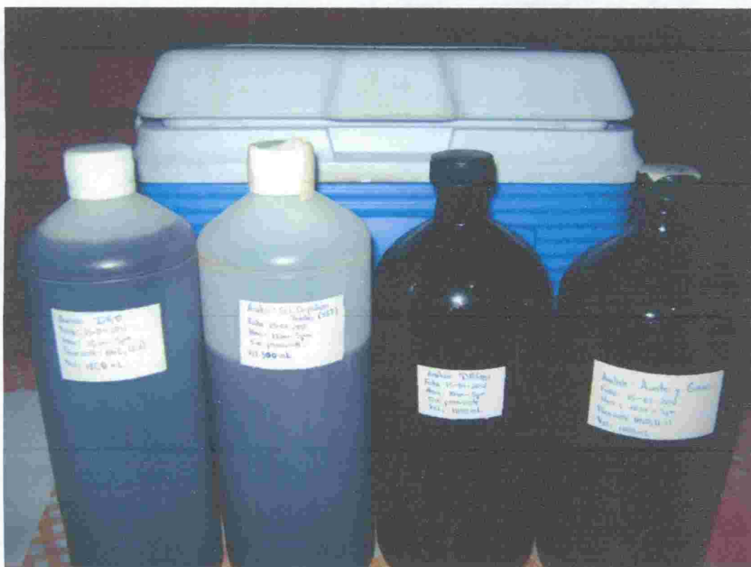
Fotografía N° 06: Botellas conteniendo las muestras de agua residual del camal Quicapata, listas para ser enviadas al laboratorio acreditado Certi Min para los análisis de DBO_5 , DQO, AyG y SST. Laboratorio de control de calidad de la Planta de Tratamiento de Agua Potable de Quicapata. Ayacucho 2011 - 2012.
