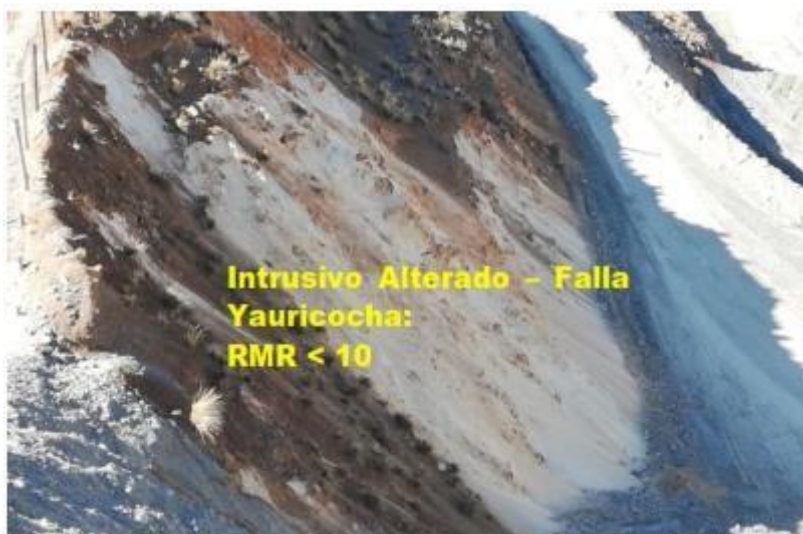
Figura 39. Celdas de Mapeo Geomecánico 05: Limos Oxidados (intrusivo intemperizado).
