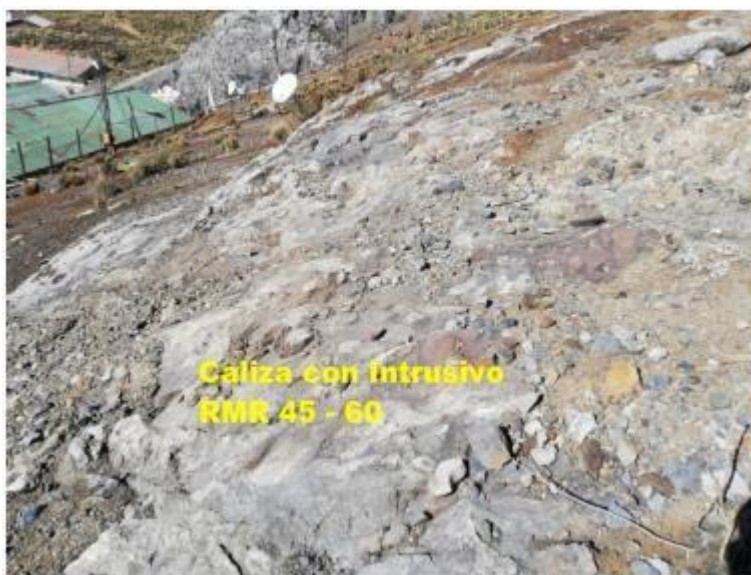
Figura 36. Celdas de Mapeo Geomecánico 02: Caliza con Intrusivo de calidad regular.
