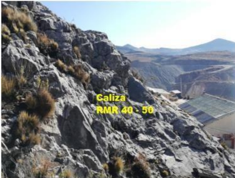
Figura 35. Celdas de Mapeo Geomecánico 01: Caliza de calidad regular.
