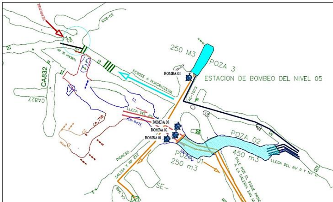
Figura 7: Bombas estacionaria Nv 5 - 400 HP
