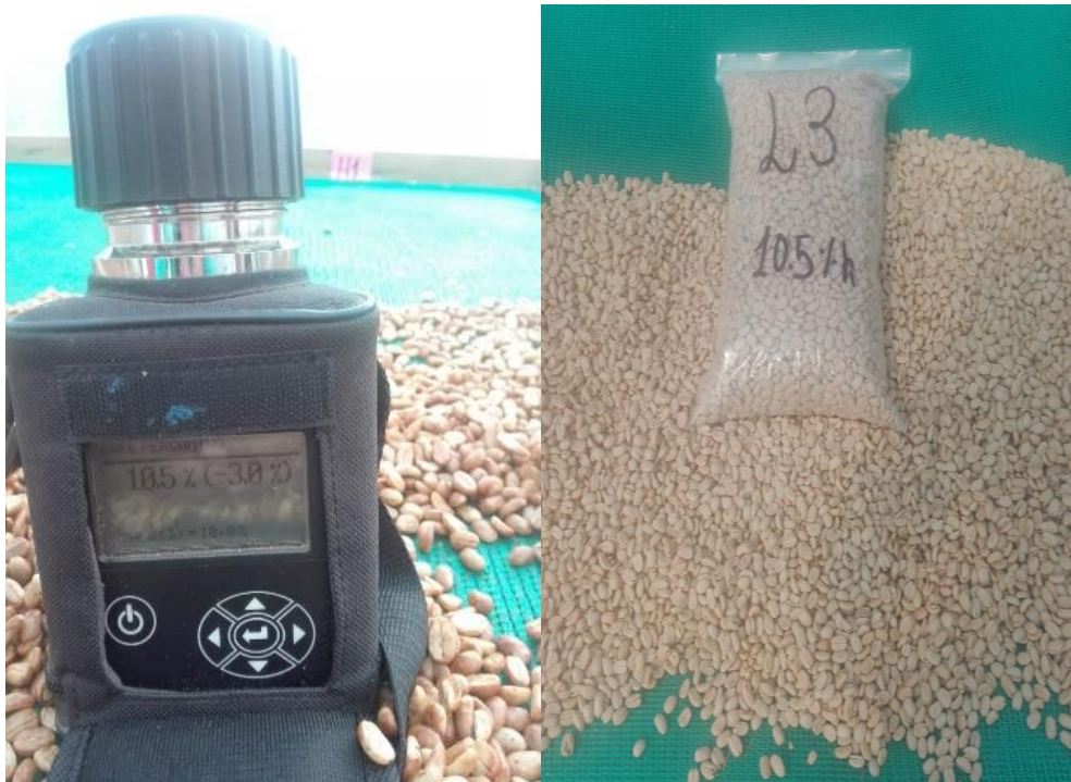
Figura C.12. Equipo de medida del parámetro humedad en el método de beneficio húmedo y recojo de muestra para el almacenado
