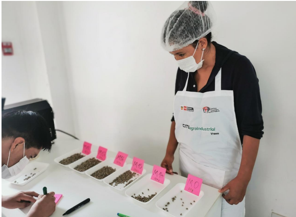
Figura C.14. Distribución de granos por tamaño de mallas (NTP - ISO 4150: 1999)
