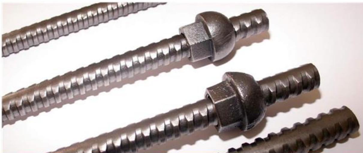
El perno de fortificación producido por CAP ha sido diseñado para reforzar y preservar la resistencia natural que presentan los estratos rocosos, suelos o taludes. Consiste en una barra de acero con resaltes en forma de hilo helicoidal de amplio paso que actúa en colaboración con un sistema de fijación formado por una placa perforada de acero y una tuerca.
