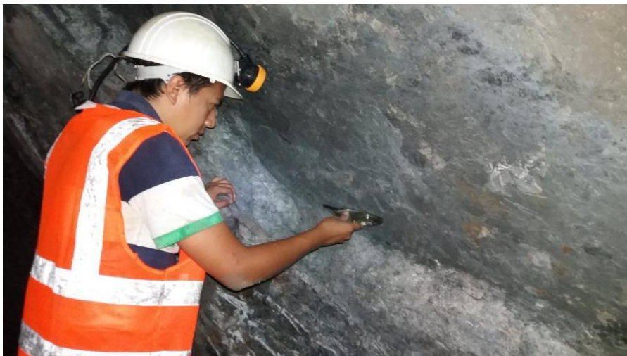
Figura 17. Toma de datos de la dirección del rumbo o buzamiento de las discontinuidades
