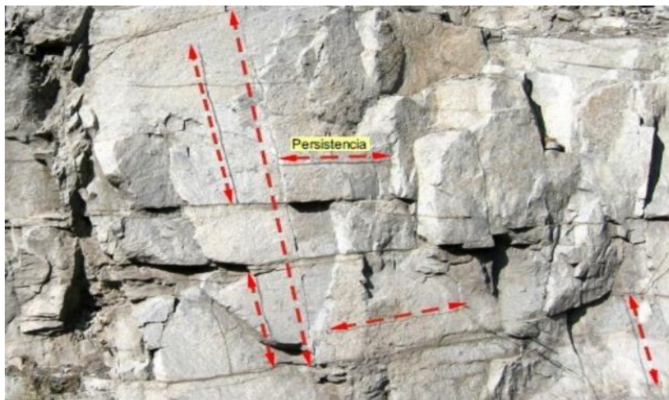
Figura 13. La persistencia a lo largo de la discontinuidad
