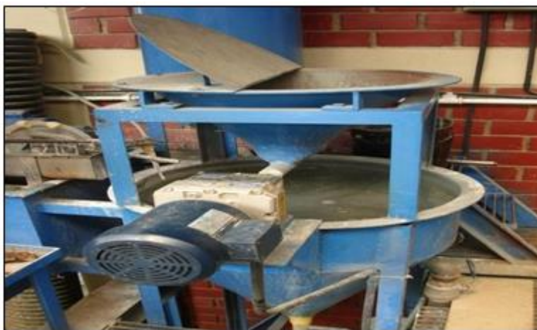
Figura 22. Cono de precipitación en la planta Merrill Crowe
