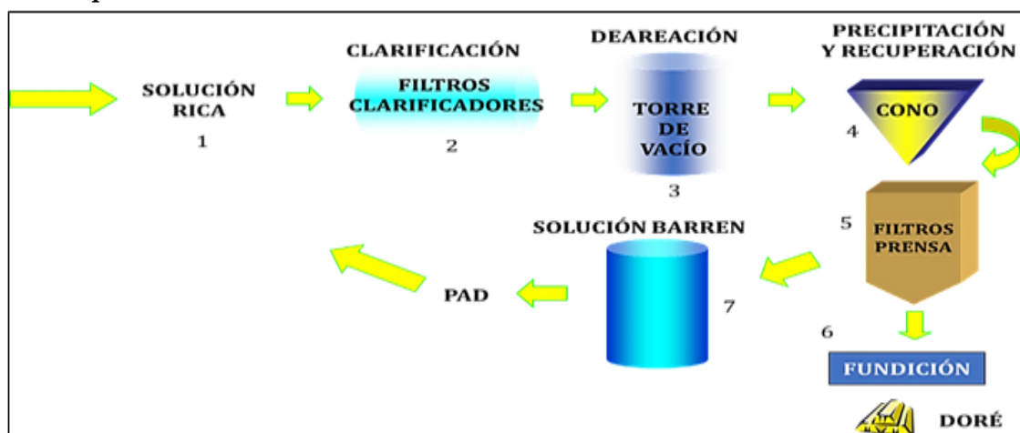
Figura 19. Esquema de la planta Merrill Crowe
