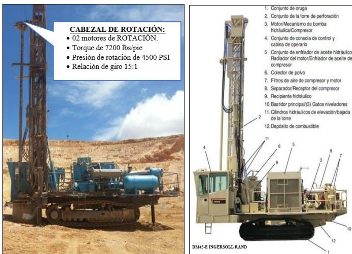
Figura 11. Perforadora DM-45 de Atlas Copco
