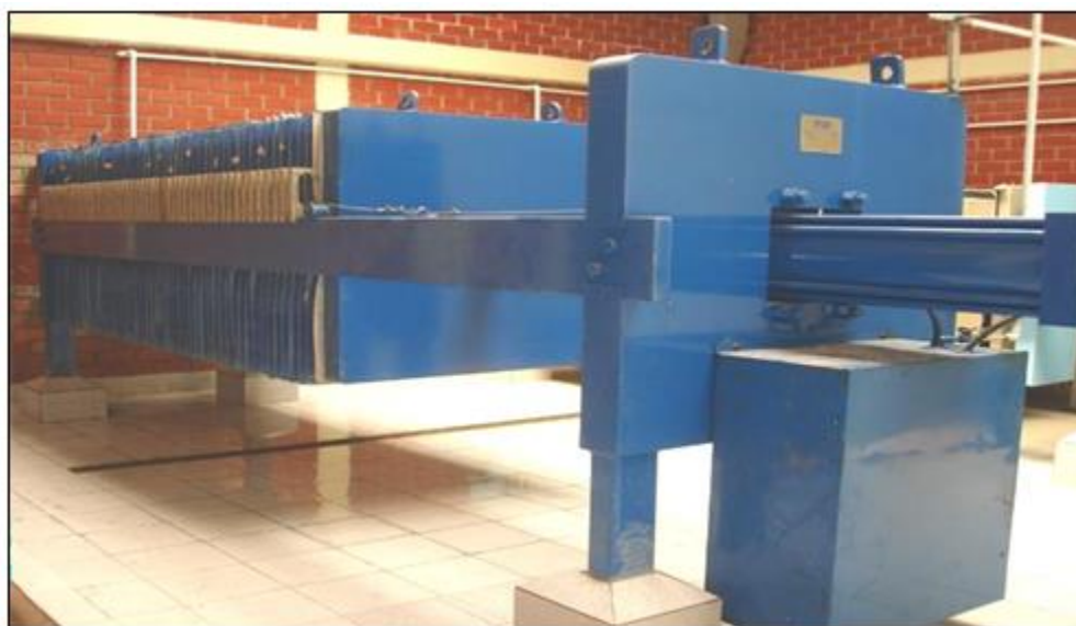
Figura 23. Filtro prensa en la planta Merrill Crowe
