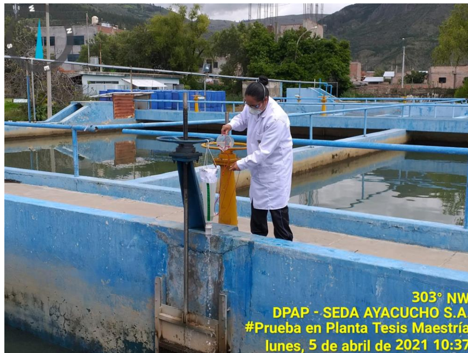
Figura C5. Fotografía de la toma de muestra con malla nyal, a la salida del sedimentador de la Planta 1.
