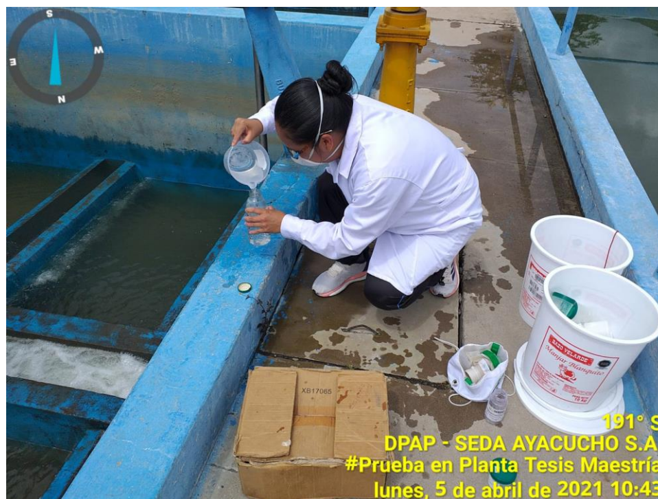
Figura C6. Fotografía de toma de muestra para fitoplancton a salida del sedimentador de la Planta 1.
