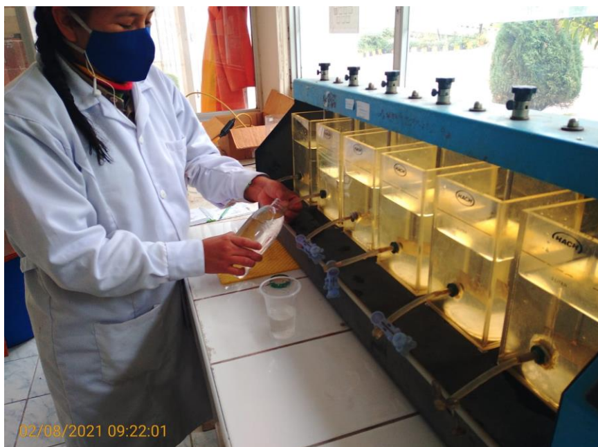
Figura C1. Fotografía de la Prueba de Jarras para la determinación de los parámetros físico – químico y cuantificación de OVL.
