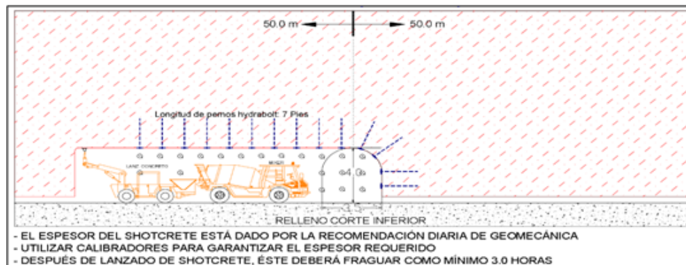
Figura 20. Ciclo de Minado – Sostenimiento mecanizado (1 hora)
