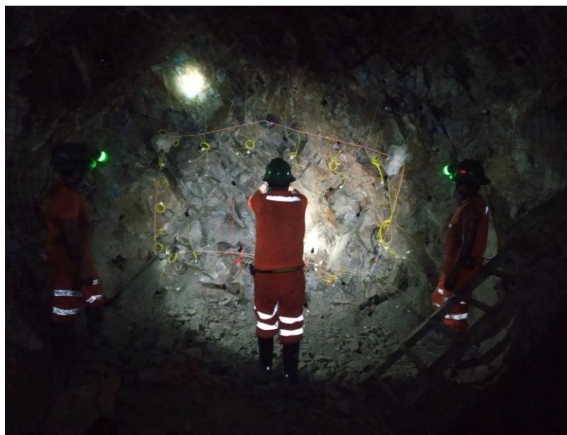
cargio del frente con faneles y pentacord em bp 685
