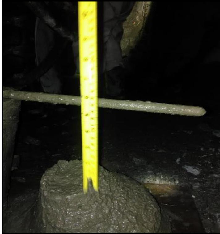
Medición de slump de concreto
