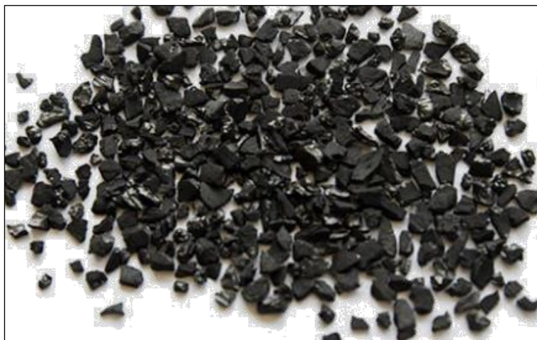
Figura 6 Carbón activado granular
