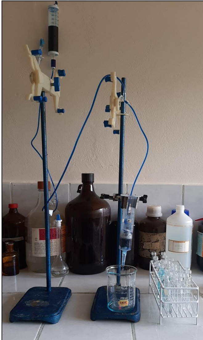
Figura 42 Sistema de adsorción de columna de lecho fijo
