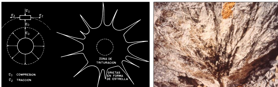
Figura 11. Trituración de la roca.
