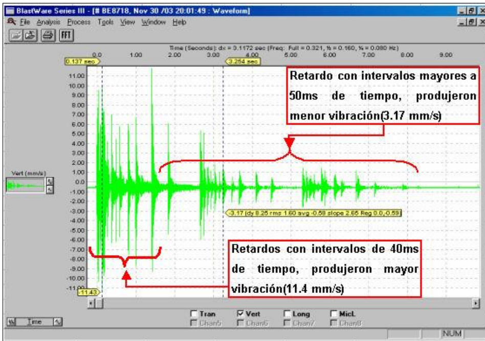
Figura 27. Aplicación de retardos mayores de 50ms.
