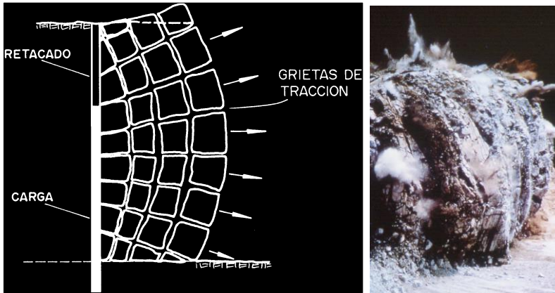
Figura 12. Rotura por flexión.
