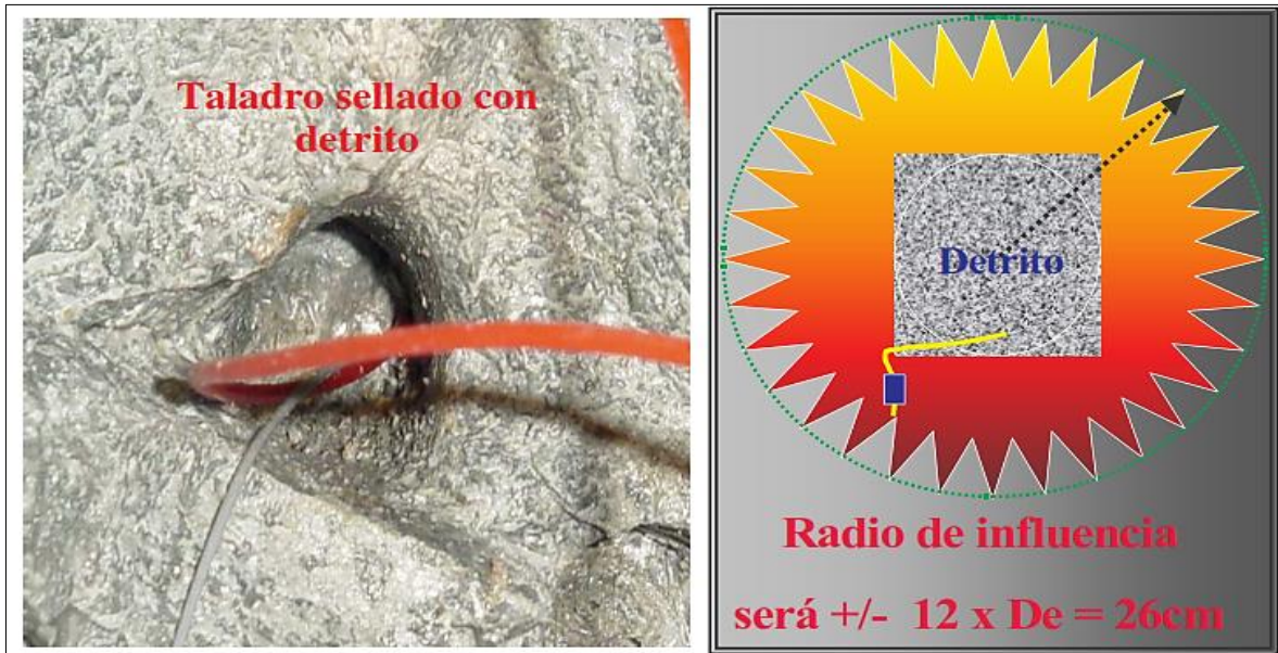
Figura 46. Taladro sellado con detrito y radio de influencia.
