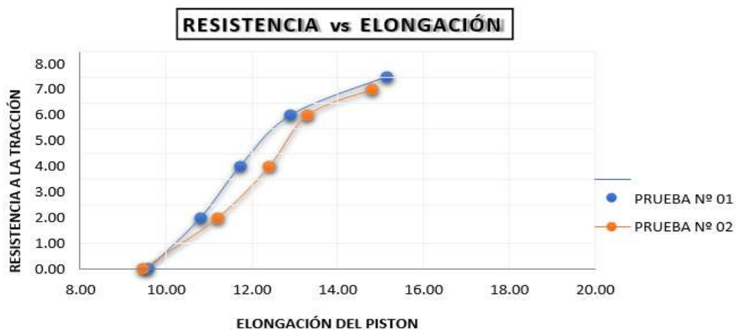
Figura 22: Curva de resistencia (TN) Vs Elongación (mm), durante las pruebas de arranque a 02 pernos Split Set.
