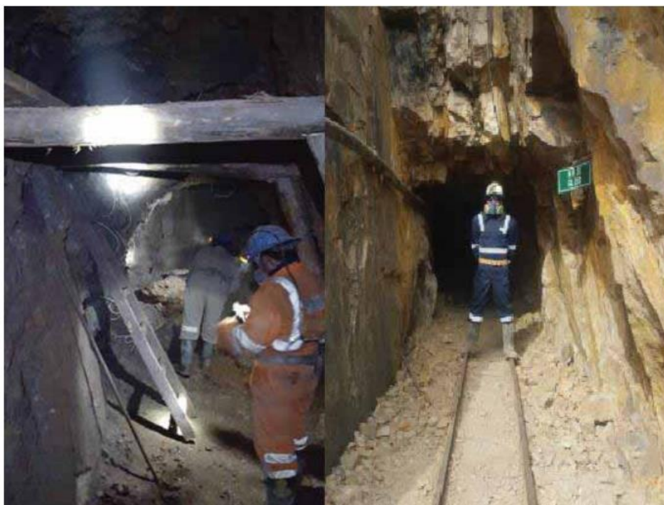
Figura 6: Mapeo geomecánico por línea de detalle
