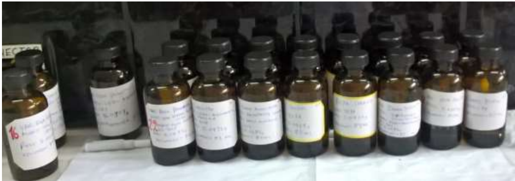
Proceso de almacenamiento y conservación de los extractos metanólicos diluidos en frasco ámbar para su posterior uso.
