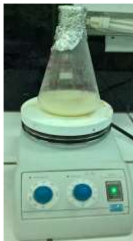
Proceso de agitación por 4 h a 300 rpm.
