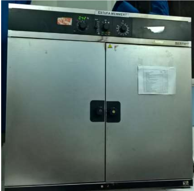
Proceso de secado en Estufa Memmert a 42 °C.
