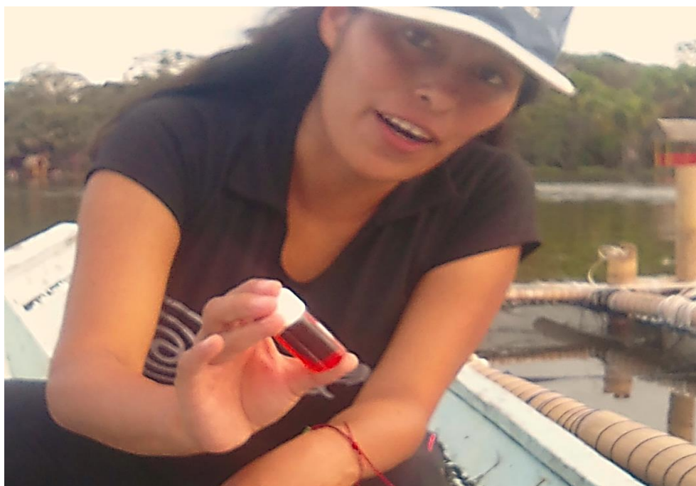
30 a. Agitando el frasco para homogenizar la mezcla entre la muestra con el reactivo que determina el nivel de oxígeno.
