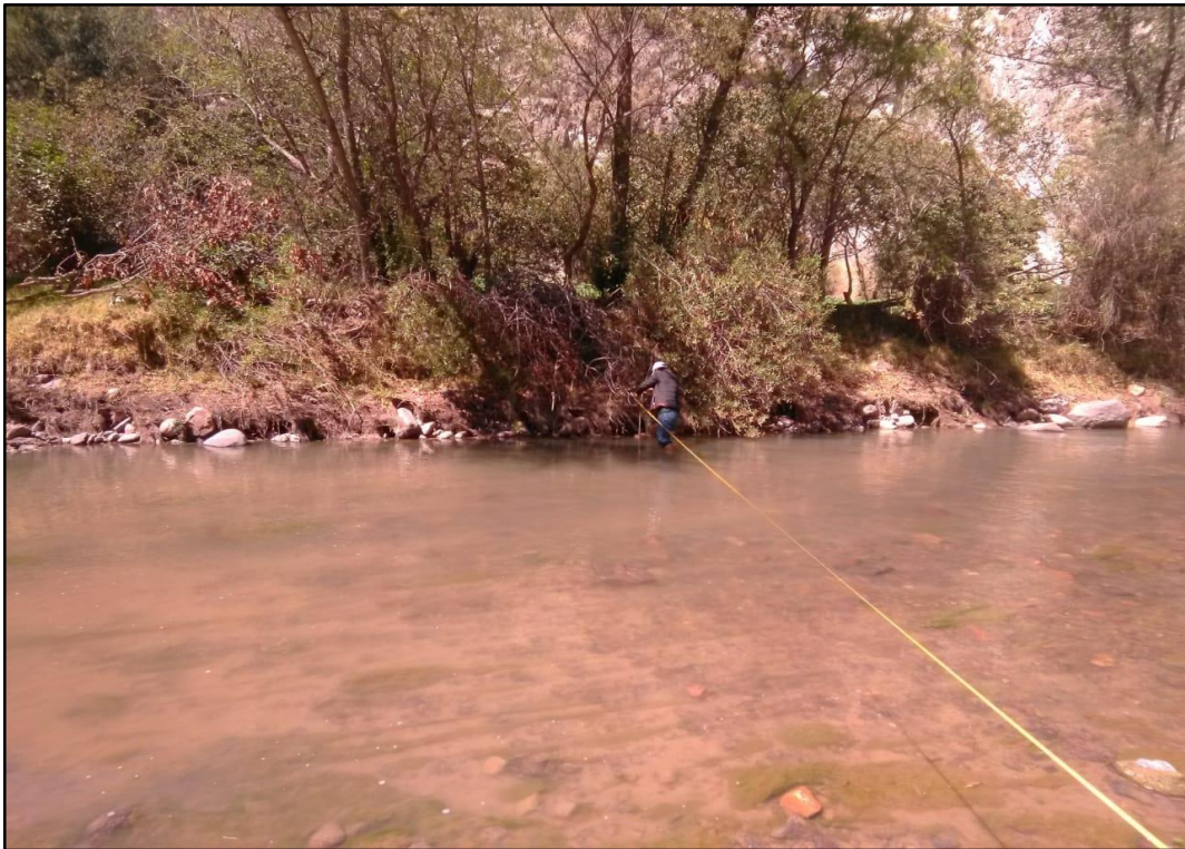
Fotografía 2: Medición del ancho estable del río, 23/09/2019.
