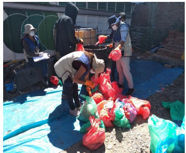
Foto 08: Determinación de la densidad de los residuos sólidos domiciliarios y no domiciliarios
