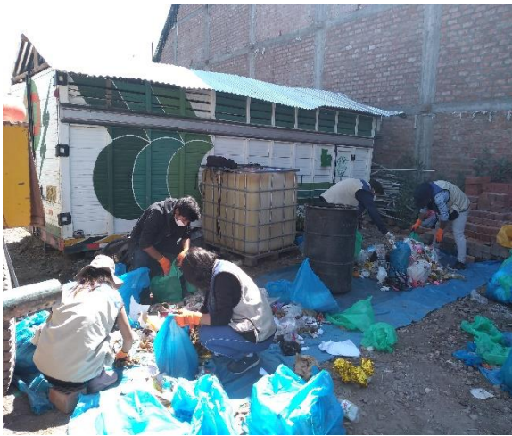
Foto 08: Determinación de la densidad de los residuos sólidos domiciliarios y no domiciliarios
