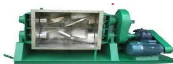
Figura 2. Amasadora-Mezcladora tipo doble Z
