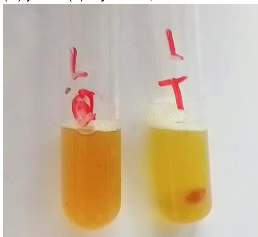
Fotografía 25. Ensayo de Lieberman-Burchard para las pruebas de triterpenos y esteroides del extracto hidroalcohólico de las semillas de quinua (Q) y tarwi (T); Ayacucho, 2021.
