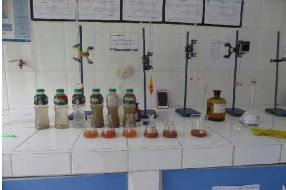
Proceso de análisis fisicoquímico de muestras de agua en el laboratorio de análisis físico y químico de la PTAP - Pichari
