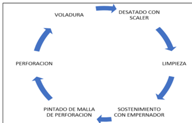
Figura 22: Ciclo de minado con sostenimiento mecanizado.
