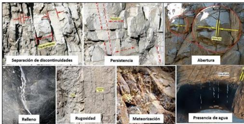
Figura 5: Otras características geomecánicas del macizo rocoso Fuente: Manual de Geomecánica- DCR Ingenieros S.R. Ltda
