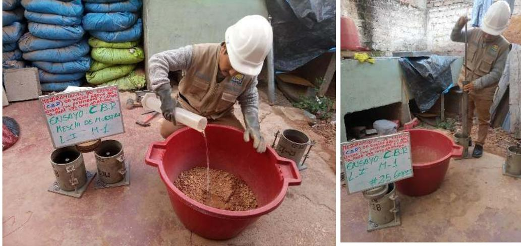
a) Adición de agua a la muestra para el ensayo de CBR
