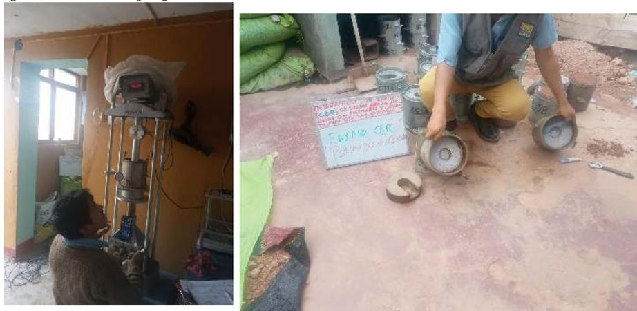
Ensayo penetración CBR
