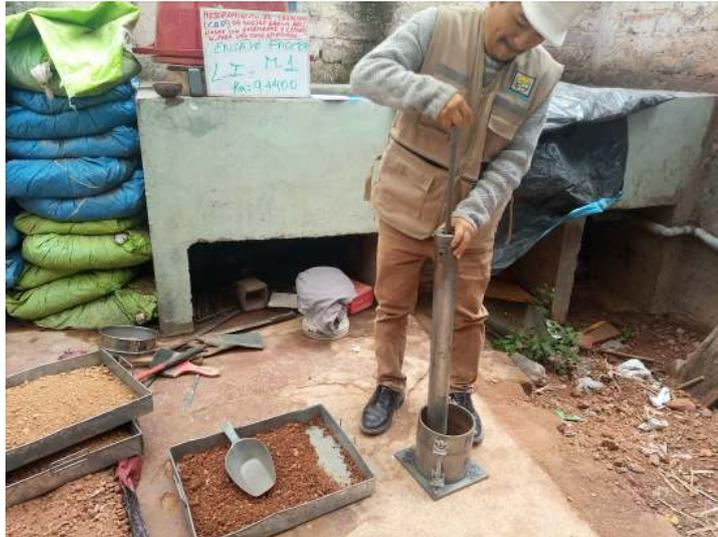
Nota: se trabajó con 4 bandejas dispuestas para 4 contenidos de humedad diferentes. Luego de la compactación se obtuvo el peso del molde más muestra y verificando su rotulado respectivo del molde.
