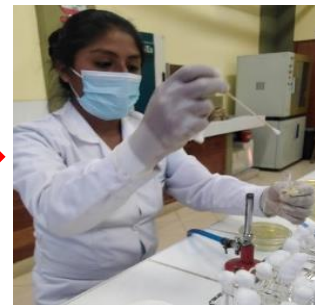
Sumergir un hisopo estéril en la suspensión.
