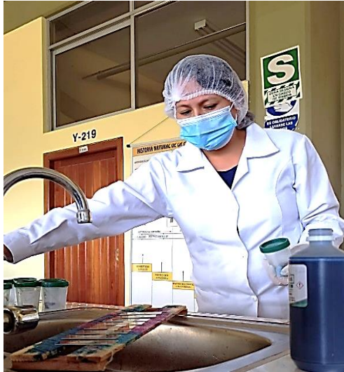
Fijado de las muestras con alcohol metílico durante 2 a 5 minutos
