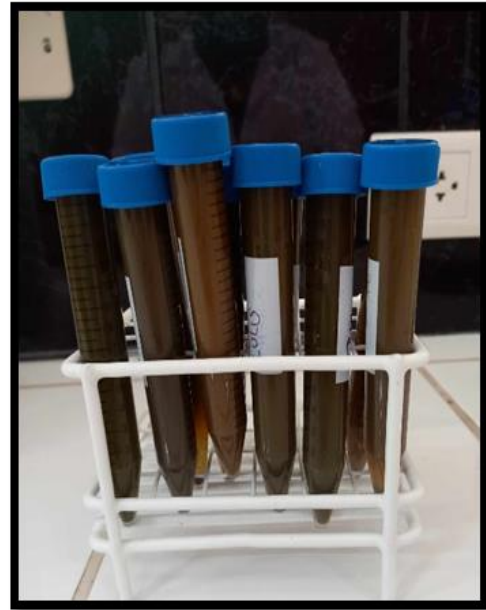
3.9. Colocar el líquido filtrado en tubos falcons y rotular.
