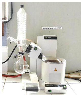
Concentración de la muestra mediante rotavapor Buchi.
