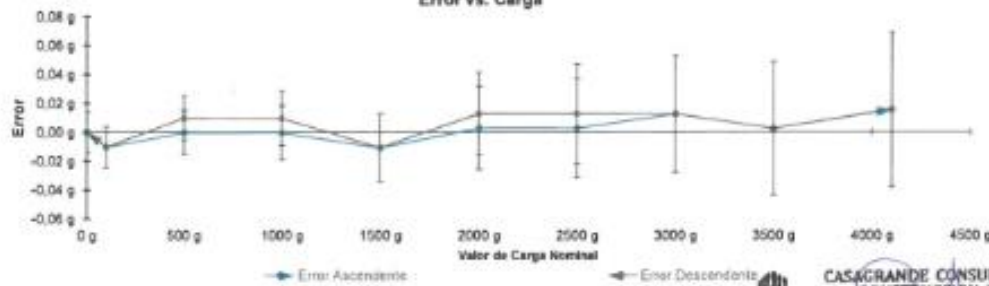
Figura 1. Gráfico para el ensayo de error de indicación.
