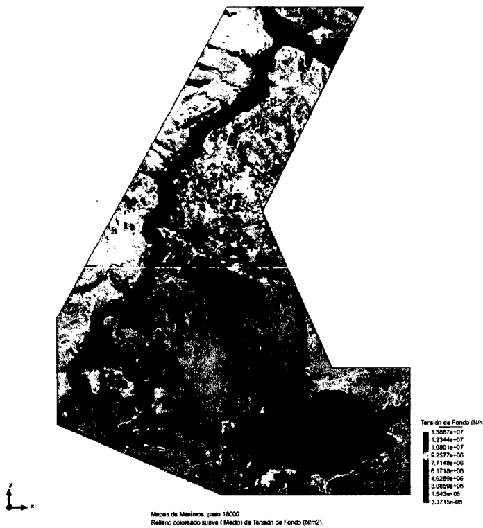
Figura 4.25: Escenario 1: Tensión de fondo máximos ( \text{N}/\text{m}^2 ).
