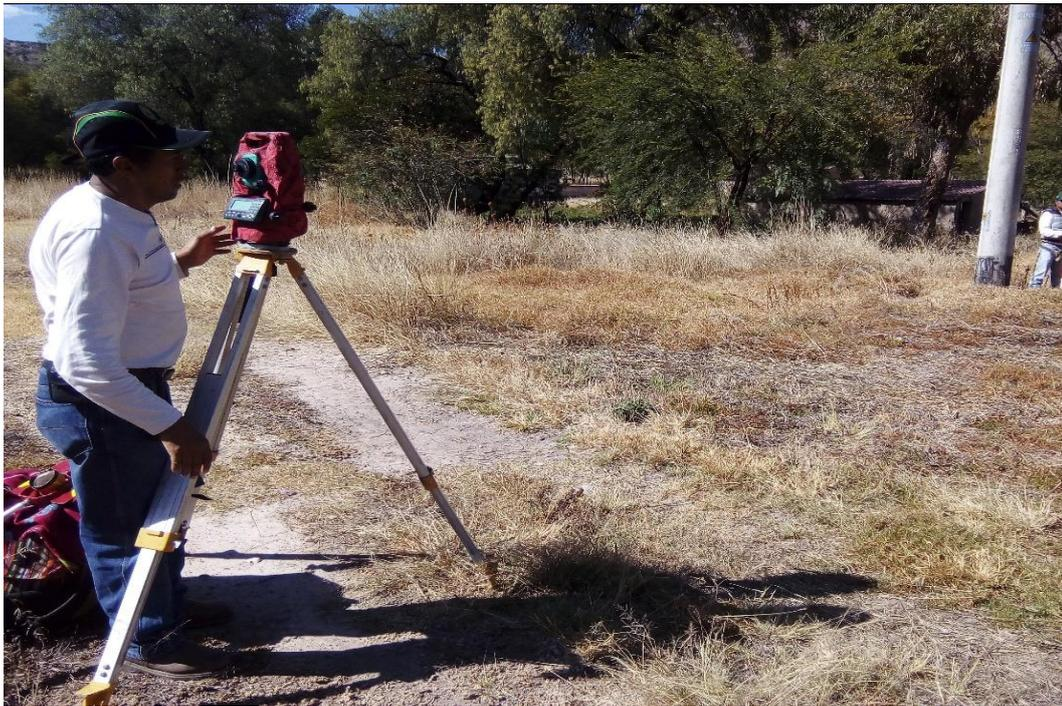
**Foto 9. Levantamiento topográfico con estación total para reservorio**
