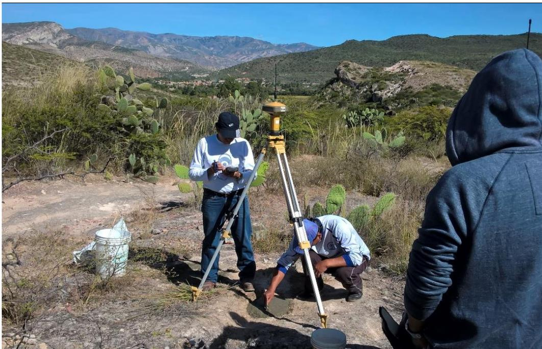
**Foto 7. Instalación del GPS diferencial en el punto t-03**
