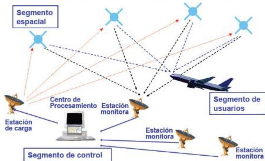
Figura 1.9. Funcionamiento de un GNSS
