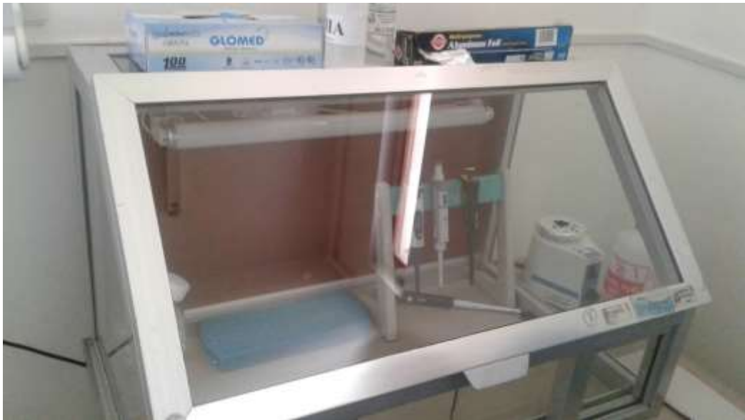
Figura 27. Cámara de vidrio cerrada y acondicionada con luz UV para suspender cebadores, ubicados en el Laboratorio de Biología Molecular del Instituto Nacional de Salud.
