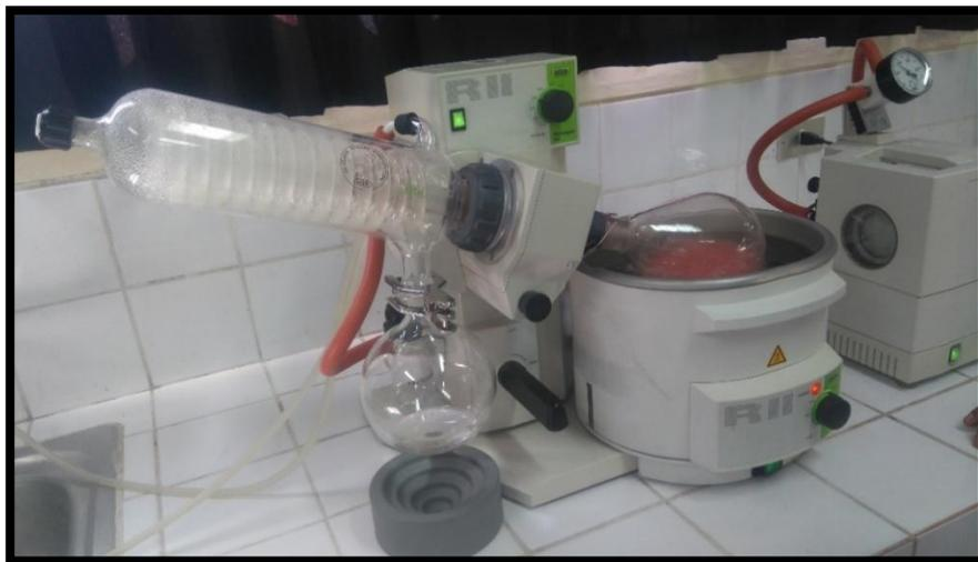
Figura 6: Proceso de concentración de jugo con un rotavapor de la muestra de Camu-Camu.
