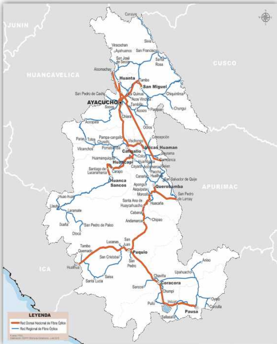
Imagen N° 2- Tendido de la Red Dorsal Nacional y de la Red Regional de Fibra Óptica en Ayacucho
