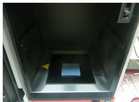
Cámara oscura del equipo registrador de imágenes Biometra UVsolo TS
