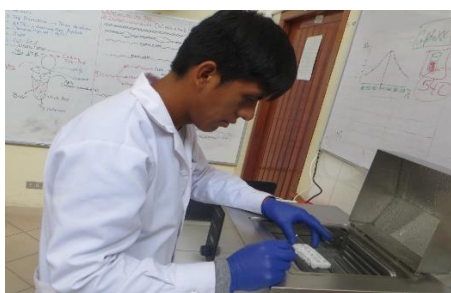
Incubación en baño maría por una hora y cuatro horas a 37 °C
