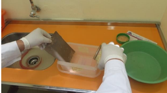
Adicionar la solución de bromuro de etidio 1% al recipiente hasta cubrir el gel de agarosa
